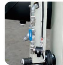
可偵測爐水濃縮電導度；當電導度達到排放標準時，鍋爐會自動將爐水排出。可穩定控制爐水的品質提高蒸汽品質，避免爐體苛性脆化、水垢產生降低鍋爐效率及水管損壞。
