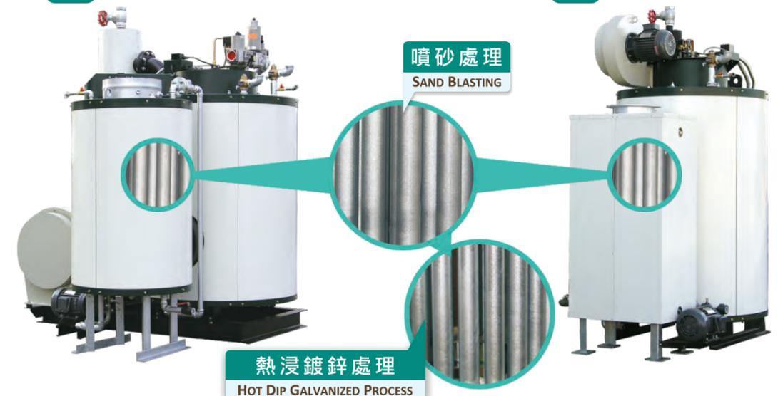
O 型及 E 型給水預熱器爐管使用無縫鋼管經噴砂、熱浸鍍鋅處理降低低溫腐蝕發生，延長使用壽命
